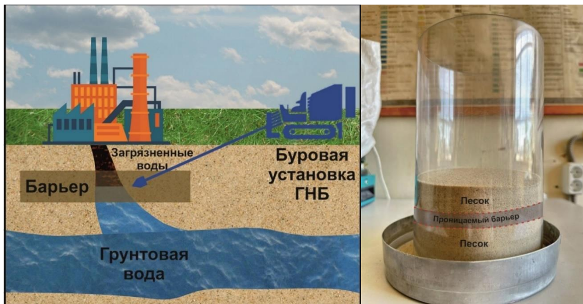
Рисунок 1. Схема применения фильтрационных инъекций (слева) и экспериментальная фильтрационная колонка (справа)
