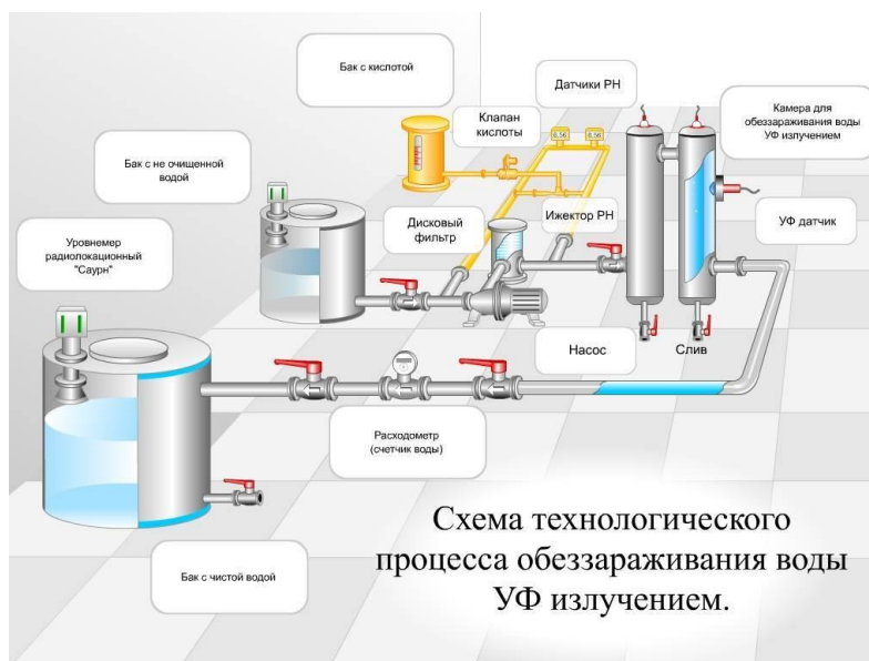
Рисунок 2. Схема технологического процесса обеззараживания воды ультрафиолетовым излучением
